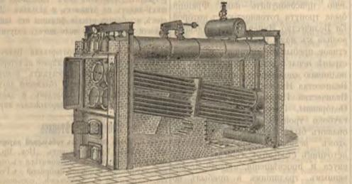
Котлы отличаются простотою и прочностью конструкціи, безопасностью въ работѣ, экономіе въ топливѣ, быстротою паропроизводства, сухостью пара и удобствомъ въ частяхъ. Нормальное количество сухого пара, образуемаго изъ этихъ котлахъ, равняется отъ 3 до 4 фунт. въ часъ на одинъ квадратн. футъ поверхности нагрева.
