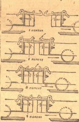
Расход времени на сцепление составов вагонеток для конки и электровозной откатки руды на шахтах, приводимая в мысли сконструировать автоматическую сцепку, по времени удара вагонетки, сцепку. Минус была предложена в бюро рационализации и изобретательства на руднике К. Либиххта в Криворожии летом 1930 года следующая конструкция
