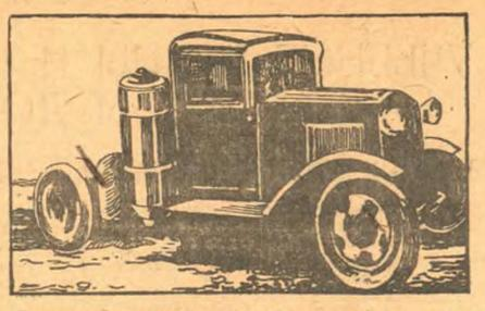
Газогенераторный автомобиль, участвовавший в испытании при походе из Ленинграда до Ростова.
