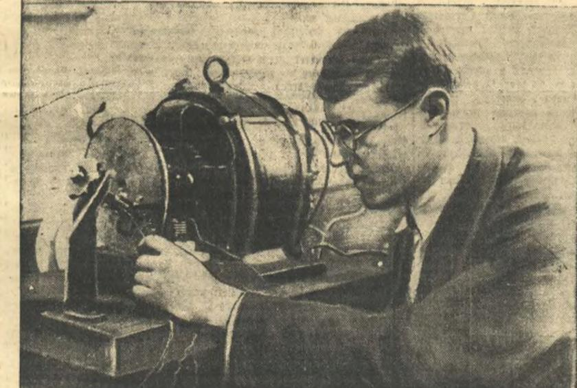
В союзном физико-техническом институте научным работником Машкиным Б. в лаборатории дефектоскопии ведется разработка методики обнаружения пороков рельс при движении дефектоскопа со скоростью пассажирского поезда. Существующие системы дефектоскопов позволяют находить пороки рельс только при скорости 3—10 километров в час. Опыты подтверждают возможность постройки скоростного дефектоскопа. На снимке: научный работник института Б. Машкин около своей установки. (Фото И. Дубровина).
