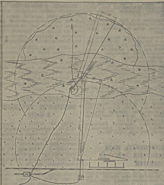
Схема трелевки сдвоенными лебедками ТЛ-3 на 1-й ЛЗУ Тимирязевского ЛСПЛХ
