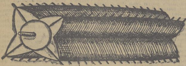
Рис. 1. Битер с обитыми железом лопастями.
