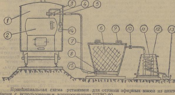
Принципиальная схема установки для отгонки эфирных масел из пихтовой лапки с использованием электростанции ППЭС-40.
