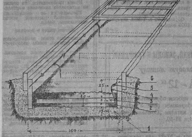
Схема устройства электрифицированного парника. Парник в разрезе: 1) шпак, 2) питательный слой земли, 3) электрод, 4) проводничок, 5) распределительный провод, 6) стенка парника.
