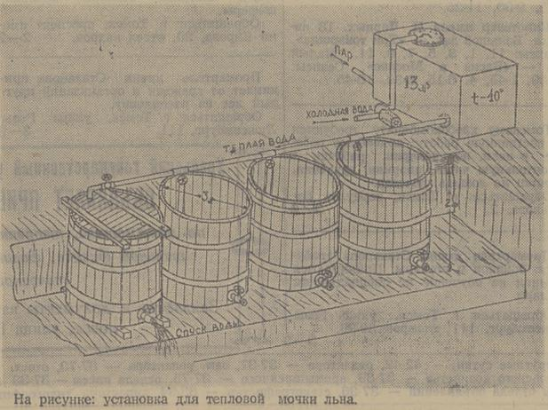
Расход воды при тепловой мочке льносомки большой: на одну весовую единицу соломки требуется до 25 весовых единиц воды. Поэтому подача воды в бак для нагрева должна осуществляться только механически.
