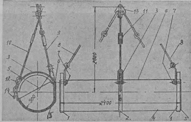
Рис. 3. Волокуша. 1 — кольца, 2 — заднее полукольцо, 3 — переднее полукольцо, 4 — обшивка, 5 — передняя кромка, 6 — передняя кромка, 7 — штырь, 8 — тяга, 9 — средняя тяга, 10 — регулировочная тяга, 11 — двусторонняя гайка, 12 — цепь, 13 — серьга, 14 — крючок.
