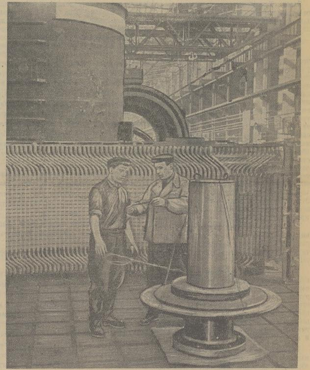
Свердловск. С опережением графика работает завод «Уралэлектрощаппарат». План четырех месяцев он перевыполнил. В мае уральские электромашинисты изготовили несколько агрегатов для крупных строек страны. На снимке: сборка мощного синхронного двигателя в 75 тысяч киловатт для Куйбышевской ГЭС. (Фотохроника ТАСС).
