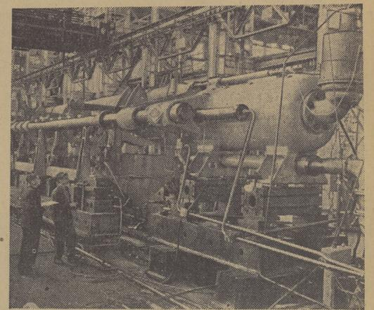
МОСКОВСКАЯ ОБЛАСТЬ. На Коломенском заводе тяжелого станкостроения изготовлен второй мощный гидравлический пресс модели ПА-016, предназначенный для испытания спирально-сварных труб диаметром 245—720 миллиметров и длиной до 18 метров. Новый пресс создает давление внутри трубы до 150 килограммов на один квадратный сантиметр. В течение часа с его помощью можно испытать до 18 труб.
