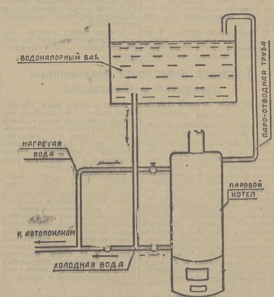
заваться пар, который может взорвать котел. Для предохранения от этого к патрубку, где присоединяется водяной предохранитель, присоединили трубу и провели ее обратно к водонапорному баку через верхнюю крышку. Эта труба наполняется водой, и в случае, если давление в котле увеличивается, вода из трубы выталкивается напором. Через открытую трубу пар выходит наружу, а когда давление уменьшается, труба снова наполняется водой.
