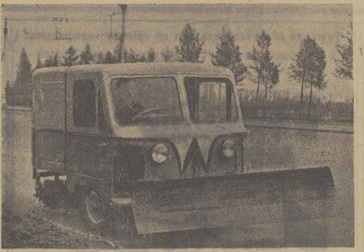
легкостью может быть заменен специальной конструкцией, позволяющей отбрасывать снег в сторону или грузить его в кузов кузов снегоуборочных машин. На снимке: новая машина «ТД-1» на улицах Москвы. (Фотохроника ТАСС).
