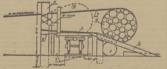
1 — прогон из крупномерного хлыста диаметром 100 сантиметров; 2 — покаты длиной 4 метра; 3 — чурки-подставки для железнодорожного сцены; 4 — столбы высотой до 2 метров и диаметром 40 сантиметров; 5 — горизонтальными отбойными бревнами; 6 — железнодорожный сцен с откинутой стойкой; 7 — накатываемый пакет хлыстов; 8 — тугые тросы; 9 — предохранительный трос.
