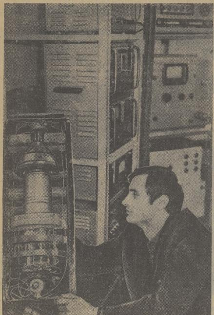
Установка, которую разработал аспирант Томского политехнического института Виктор Кузнецов, называется сцинтилляционный спектрометр.
