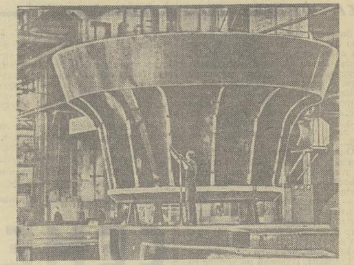
В цехах Ленинградского металлического завода имени XXII съезда КПСС идет обработка деталей шестой турбины для Асуэльской гидроэлектростанции в ОАР. Сейчас на разметочной плите один из цехов завода повисло рабочее колесо турбины. После того как будет закончена разметка, оно уйдет для дальнейшей обработки на карусельном токарном станке.
