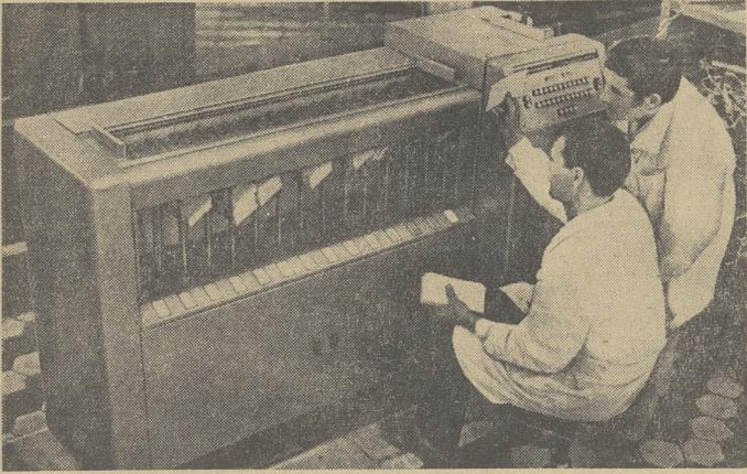
**МАРИССКАЯ АССР.** Завод «Электротоматика» (г. Юшкар-Ола) приступил к серийному изготовлению электронной сортировки СЭ80-3. Она предназначена для автоматической группировки, выборки и подборки перфокарт в соответствии с заданной программой. Скорость подачи перфокарт 700 штук в минуту. Автомат имеет применение на машиностроительных станциях, вычислительных центрах.
