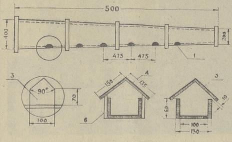
Площадь сечения каналов определяют, исходя из количества воздуха, подаваемого вентилятором, и максимальной скорости этого воздуха в каналах. А она должна быть не выше 10 м/сек — в главном и не более 5 м/сек в боковых. Устройство каналов показано на рисунке.
