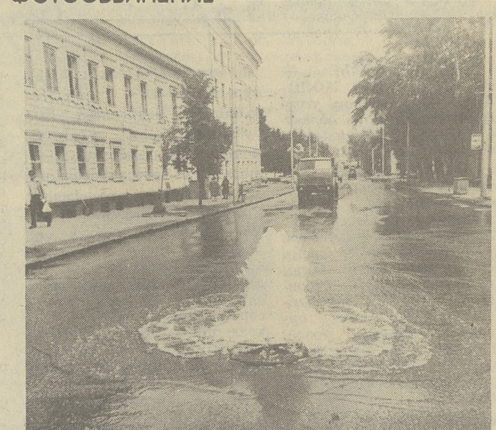
Вот такой фонтан вырвался два дня назад из ливневой колоды по пр. Фрунзе, неподалеку от детской областной больницы № 3. Море воды хлынуло на тротуар. В чем причина? Для ремонтных целей был отключен четвертый коловод. Чтобы быстрее освободить его от воды, пришлось сделать сброс в ливневую канализацию. Намерения, конечно, благие, но сколько чистой воды потрачено зря. К тому же сколько неудобств пешеходам и водителям транспорта... Фото Е. Лисицына.
