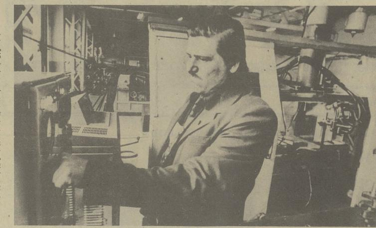
Первый в лесной отрасли страны цех порошковой металлургии, что на Асиновском трактороремонтном заводе, пополнился еще одной сложнейшей установкой — «Киев-7». Теперь методом плазменного напыления можно будет восстанавливать дефицитнейшую деталь — коленчатый вал лесовозных автомобилей. Три валя уже направлены на испытания в лесхозовской области.
