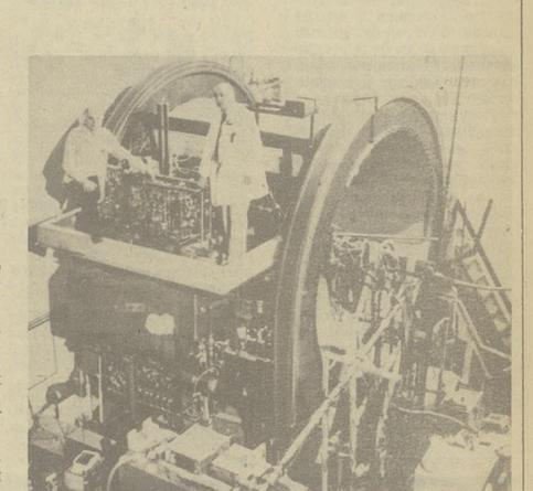
Первый в мире циклотрон на сверхпроводящих прощел последние испытания и вскоре будет установлен в одном из госпиталей в Детройте. Прибор предназначен для лечения некоторых типов раковых заболеваний с помощью нейтронного излучения. НА СНИМКЕ: американские ученые ведут наладку циклотрона «K-100». Телефото Рейтер — ТАСС.
