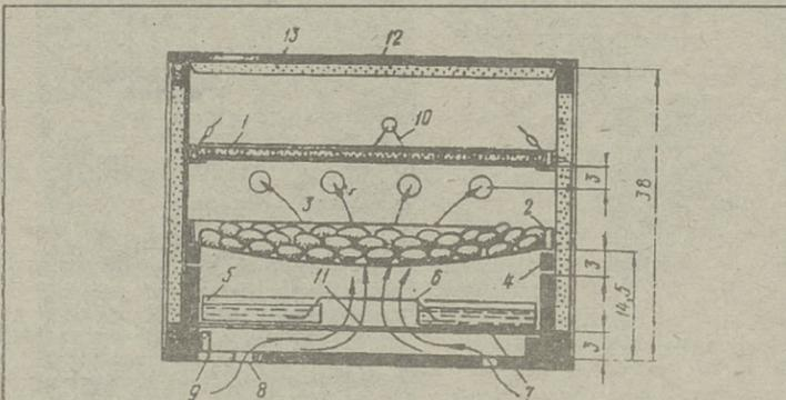
Разрез инкубатора (размеры в см): 1 - нагреватель; 2 - лоток с яйцами; 3 - отверстие для вентиляции в стенке; 4 - подкладываемые бруски; 5 - ванночка с водой; 6 - мешковина; 7 - второе дно; 8 - отверстие для вентиляции в первом дне; 9 - первое дно; 10 - электрошнур; 11 - отверстие во втором дне и в ванночке для вентиляции; 12 - крышка инкубатора; 13 - войлок.
